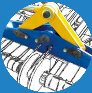
Kinematik för hopfällning av de yttre pinnarna
