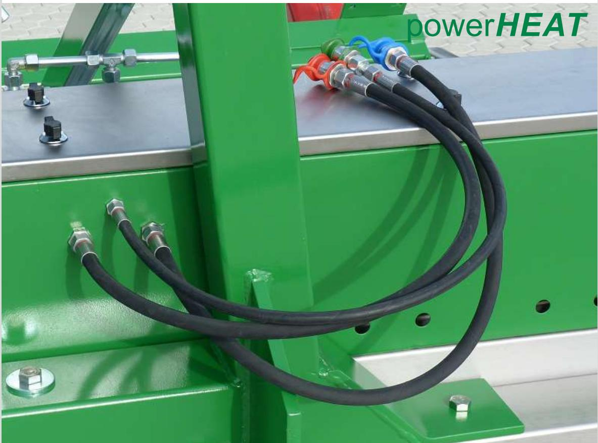
Dazu ist ein doppelwirkendes Steuergerät und ein druckloser Ölrücklauf am Traktor notwendig.
