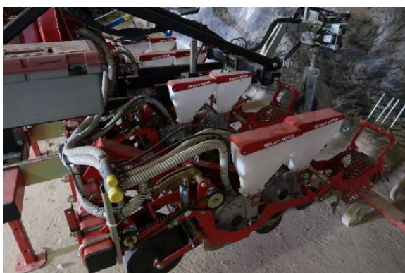
Miniair Nova såmaskin för morötter och rödbetor. 4 dubbelrader per sådrag.
