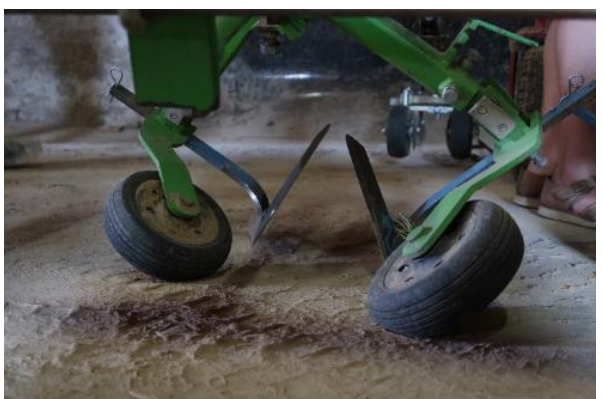
Hemmabyggt hacka med snedställda gåsfotskär för att bearbeta sidorna på kuporna
