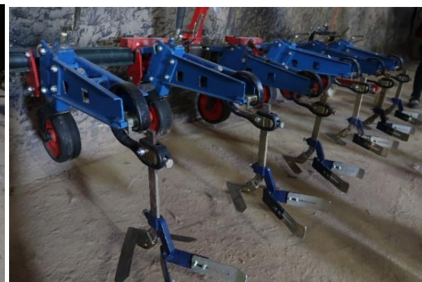
Radensare med vinkeljärn som kastar in jord i raderna.
