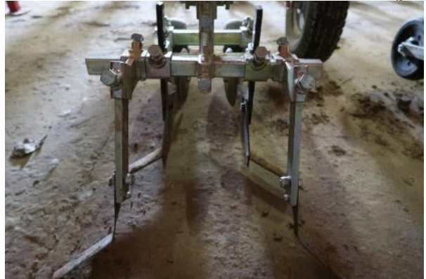
K.U.L.T./Kress Duo-parallelogram precisionsradensare med två stödhjul per rad som arbetar uppe på kupan med morötter.
