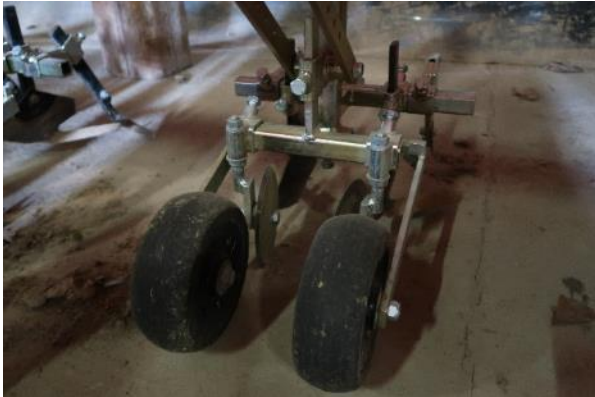
K.U.L.T./Kress Duo-parallelogram precisionsradensare med två stödhjul per rad som arbetar uppe på kupan med morötter.
