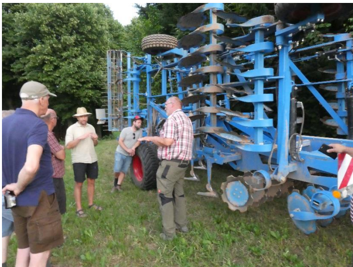
Lemken Koralin, grund överlappande utskärning, 8 cm överlappning, tallrikar framme, följd av gåsfot
