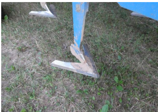
Hemligheten är grund skärande stabila upphängda gåsfot, här också med hårdmetallbeläggning
