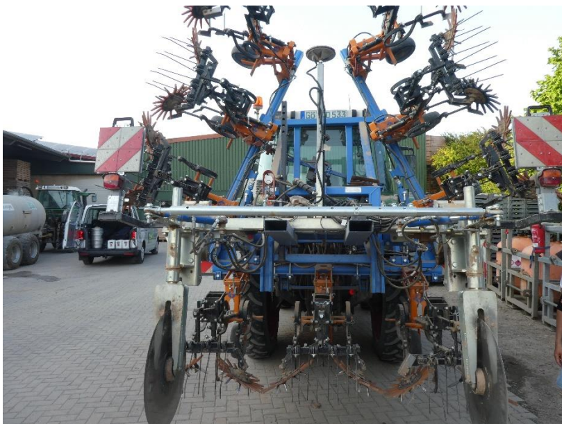
Radrensare bestyckat med fingerhjul, efterharv, gåsfot, i sockerbetor
