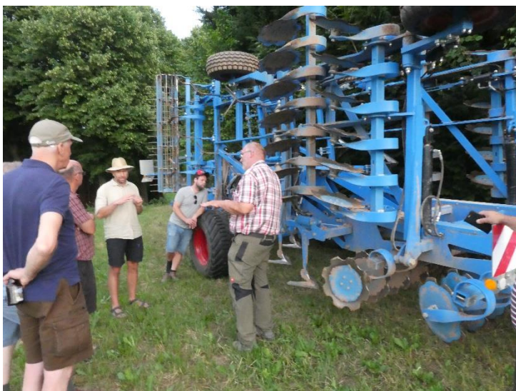
Lemken Koralin, grund bearbetning med 8 cm överlappning. Tallrikar framme, gåsfötter efter.
