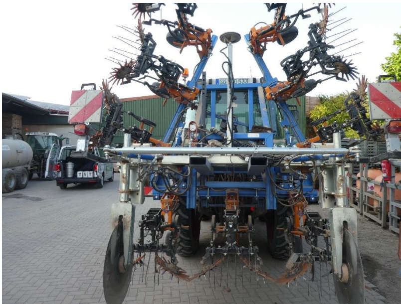
Radrensare med fingerhjul, efterharv och gåsfot. Användning framförallt i sockerbetsodlingen.
